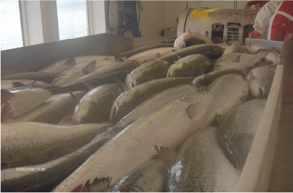
Figur 11. Bildet viser elektrobedøvd laks som venter på å bli bløgget. Kombinert bløgge- og slagmaskin (med manuell innmatning) vises bak i bildet, person som bløgger manuelt står bak til høyre.
