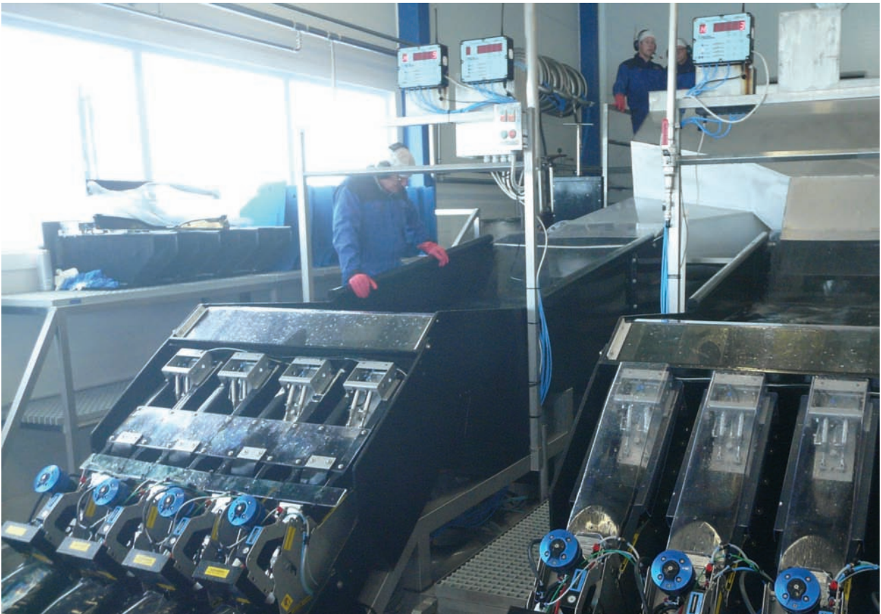
Figur 6. Bildet viser en dobbel rigg á 4 parallelle SI-5 slagenheter. Fisken svømmer selv ut av adferdskaret (her vist uten gummidekke) inn i en bås som leder den ut i rennen ned til slagenheten. På riggen til venstre synes rennen der fisken snus automatisk før den kommer ned til bløggemaskinen.
