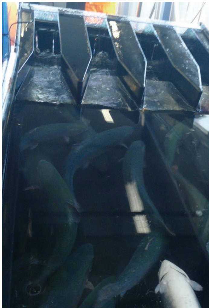
Figur 28. Slakteri C. Bildet viser laks i adferdskaret. Fra båsene øverst i bildet strømmer det vann inn i karet, som stimulerer fisken til å svømme fram og ut i rennen som fører ned til slagmaskinen. Bildet viser fisk som svømmer motsatt vei og fisk som flyter opp ned. I dette tilfellet måtte karet ha personell stående som styrte fisken mot utgangene.
