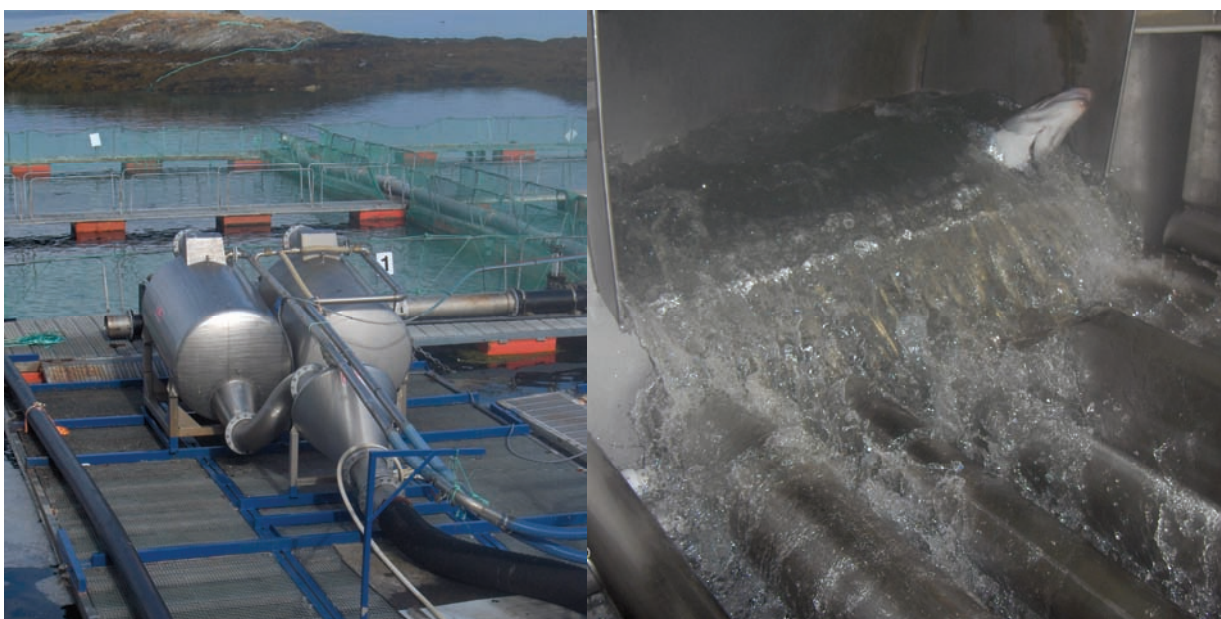
Figur 27. Slakteri C. Bildet til venstre viser ventemerder og dobbel vakuumpumpe plassert på flytebrygge, som gir lav løftehøyde i sugefasen. Bildet til høyre viser laks på vei inn i avsilingen der fisken størrelsessorteres. Mindre fisk faller mellom rørene og ledes til annen rigg enn den større fisken.
